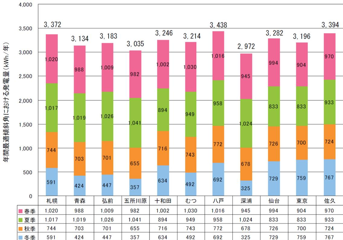
図 2-6 年間最適傾斜角における発電量（他地域との比較）
